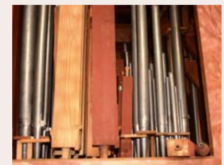
Blick in das Pfeifenwerk (von rechts nach links): Prinzipal 4', Mixtur, Quint, Oktav 2', Flöte 4', Gedeckt 8', Hohlflöte 8', Prinzipal 8'
