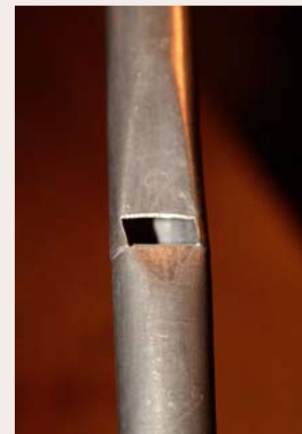
Pfeife des Registers Hohlflöte 8' mit einfachem Labium und eingravierter Tonbezeichnung (P. Hötzel 1793)
