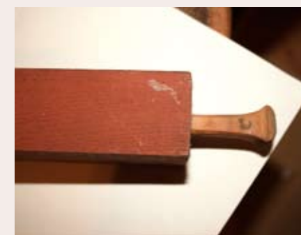
Oberes Ende einer gedeckten Pfeife (Flöte 4', Eiche) mit vierkantigem Spund (N. Rummel 1754)
